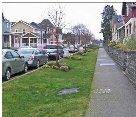
Figura 16: Un fossato d'infiltrazione (Fonte: EPA).
