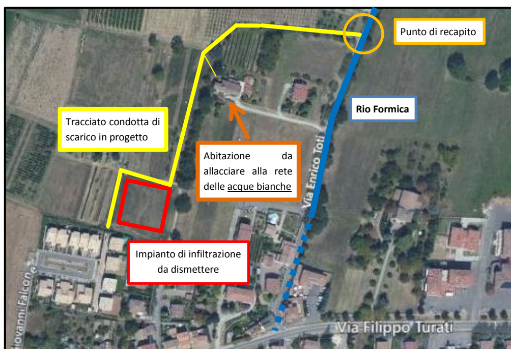
Figura 2: Foto aerea dell'area dove verrà posata la condotta di scarico tratta da Bing Maps.
