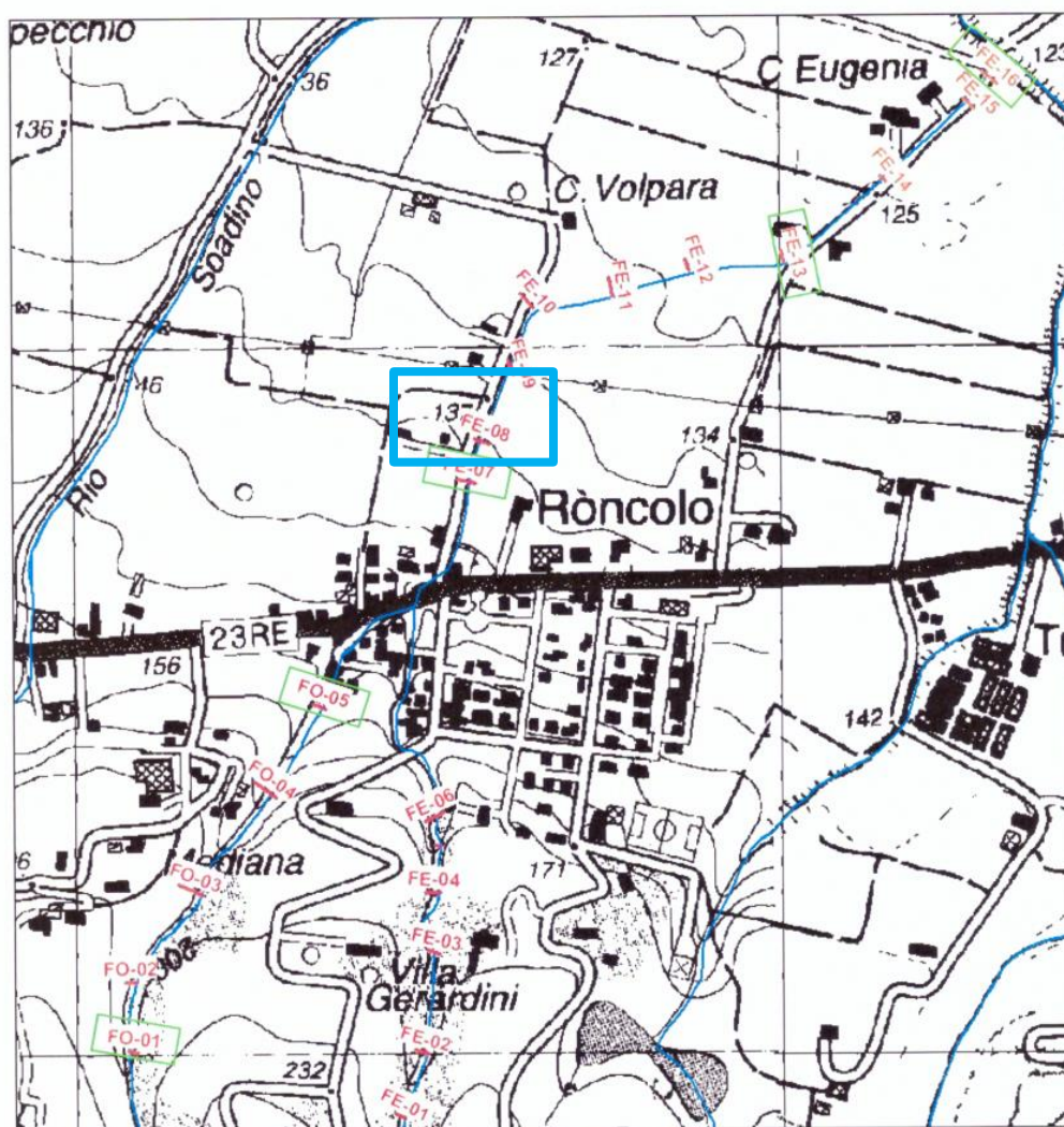
Fig. 60 Inquadramento planimetrico rio Formica e rio Formica ovest: in cornice verde le sezioni corrispondenti alla chiusura dei sottobacini idrografici di calcolo delle portate
