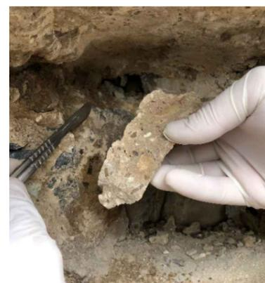
Al fine di prelevare un campione di malta sono stati rimossi alcuni conci in pietra del paramento esterno. La struttura esterna risulta perfettamente stabile ed ancorata; la malta dei giunti è tenace e di buona composizione. I prelievi sono stati effettuati a 23 cm di profondità.
