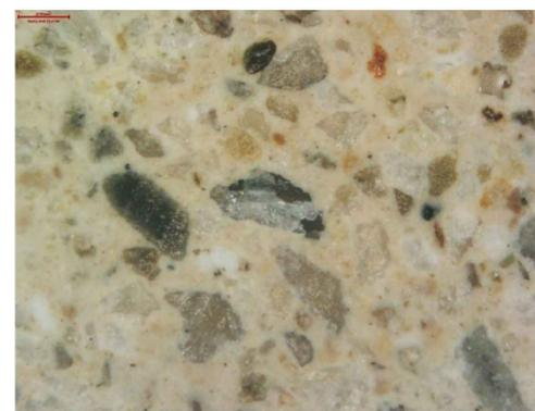
Sezione lucida, dettaglio ingrandimento 400X
